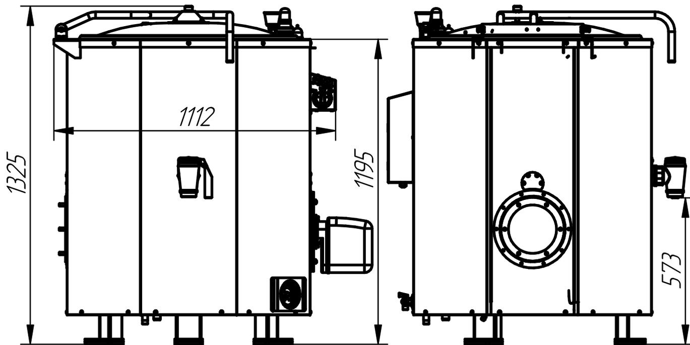
Котлы пищеварочные дизельные типа КПДМ предназначены для кипячения воды, приготовления бульонов, первых блюд, напитков, компотов и т.п.. Слив готового продукта осуществляется краном 2" на передней панели. Нагрев продуктов в сосуде осуществляется способом "пароводяной рубашки". При отсутствии воды в "пароводяной рубашке" срабатывает автоматическое отключение котла. Котел комплектуется горелкой дизельной Lamborghini ECO-3R. Возможно использование в качестве топлива газ, при замене горелки.
